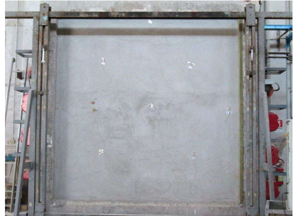
Resim 8: Test Öncesi Ölçüm Yapılan Sıvalı Yüzey[6].
