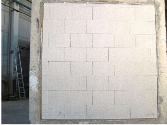
Resim 9: Test Sonrası Numunenin Aleve Maruz Kalan Yüzeyi[6].
