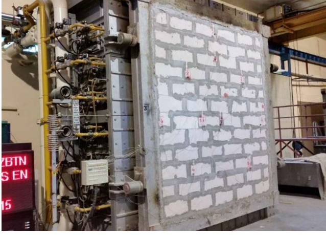
Görsel 4: Gazbeton Blok Ürünleri Yangın Dayanım Testi
